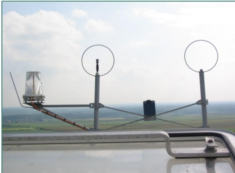
**Figure 11 : Photographie d'un exemple de balisage aéronautique**
