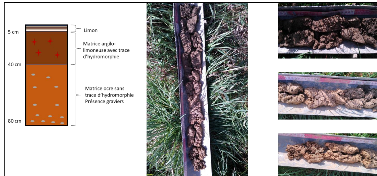
Figure 55 : Illustrations du profil de sol n°3 (Source : NCA environnement)
