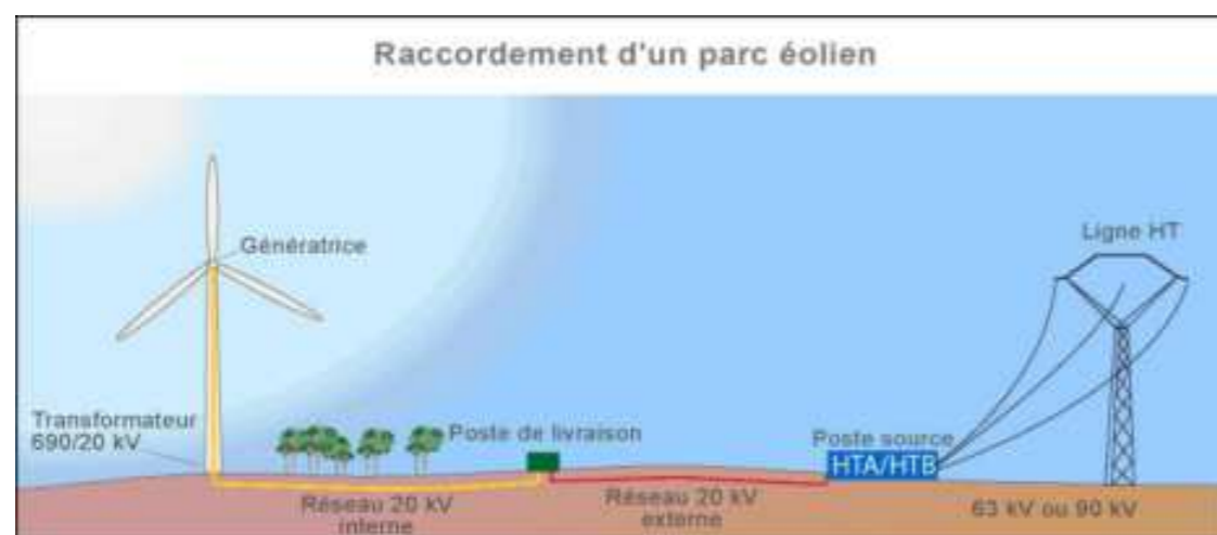
Figure 26 : Organisation générale du raccordement électrique au réseau de distribution ou de transport
