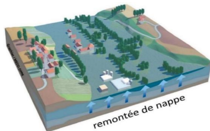
Figure 15 : Le phénomène d'inondation par remontée de nappe (Source : georisques.gouv.fr)
