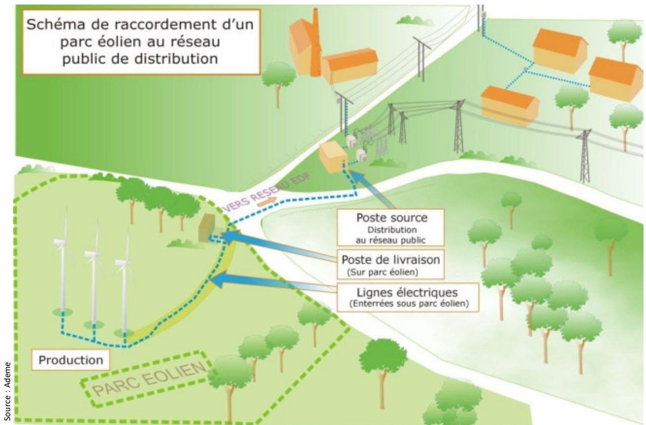
Figure 20 : Raccordement électrique au réseau de distribution
