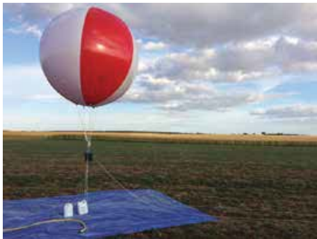
Détecteur automatique d'ultrasons attaché sous un ballon pour étudier l'activité des chauves-souris pendant une EIE. © J. Sudraud
