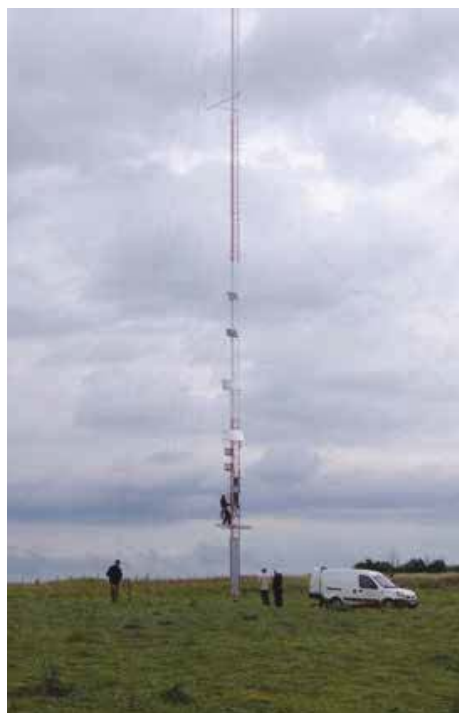
Mât de mesures météorologiques avec des détecteurs installés pour enregistrer l'activité des chauves-souris en altitude, à hauteur de la zone de collision, France. © J. Sudraud
