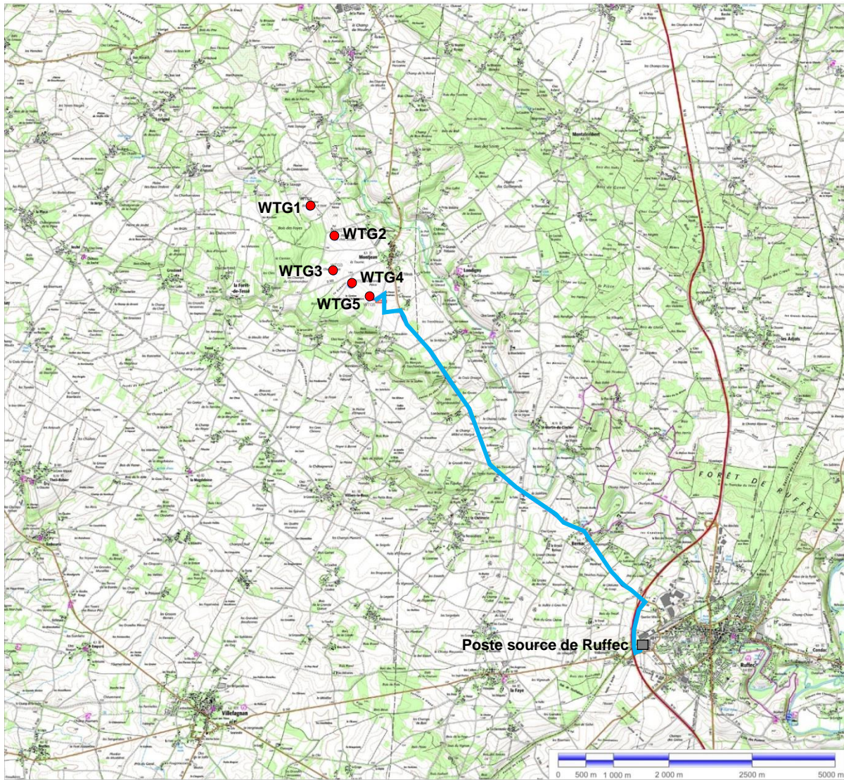
Figure 15 : Tracé prévisionnel de la solution de raccordement au poste source de Ruffec
